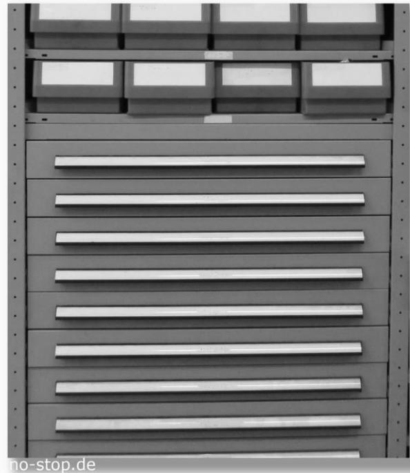
Da ein solches Kleinteilelager äußerst kompakt ist können Sie es in unmittelbarer Nähe zur Konsolidierung bzw. Packerei anordnen. Dadurch können Zählwaagen sowohl zur Kontrolle genutzt werden wie auch unmittelbar am Schubladenschrank.
